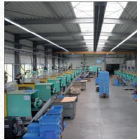
Die Materialversorgung dieser hochmodernen Fertigungslinie wird durch eine Zentralförderanlage mit vorgeschalteter Trocknung gesteuert. So können wir dauerhaft eine gleichbleibende Materialqualität gewährleisten.
